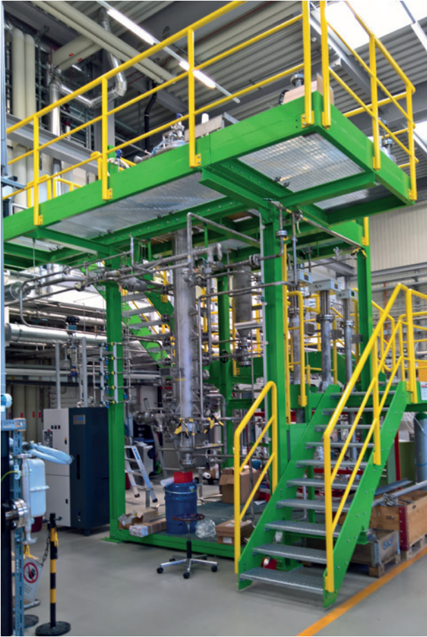
Abbildung 12: SCCER BIOSWEET-Pilotanlage (TRL 6) zur Untersuchung der Auswirkungen von Druck (bis zu 10 bar), Gasgeschwindigkeit und Partikelgrösse auf die verfügbare Stoffaustauschfläche im Wirbelschicht-Methanisierungsreaktor (Foto: PSI). Diese Erkenntnisse können zur Verbesserung der Modelle für die Reaktoroptimierung und Prozesssimulationen verwendet werden. Die Reaktorsimulationen werden durch Experimente in dieser Anlage validiert.
